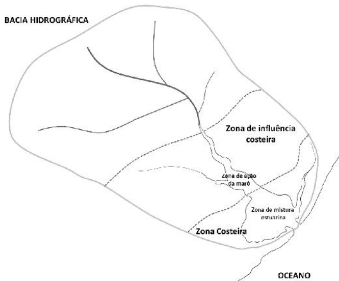
Figura 5. Esquema da delimitação da zona costeira e da zona de influência costeira a partir da definição de estuário de Kjervfve (1987). Adaptado de Kjervfve (1987).
